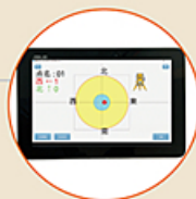
杭打機操作者の画面
